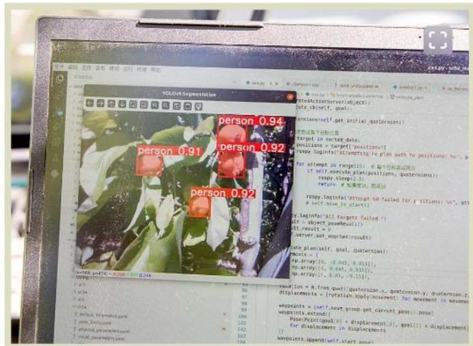
ロボットアームのカメラは、確率を用いてリンゴを識別する。画面の数値は、「1」がコンピューターがリンゴを識別したと100%確信していることを意味する。ここではリンゴにソフトウェアの標準設定である「person(人物)」のラベルが付けられているが、研究者達はこのデモの後、ラベルを「apple(リンゴ)」と付けるようにプログラムを修正した。(ロス・コートニー/本誌)
