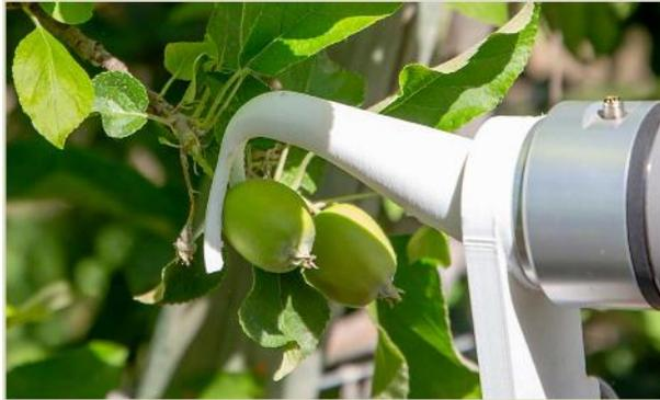
ワシントン州プロッサ近郊で6月に行われたワシントン州立大学の農業工学専攻の学生達によるデモンストレーションで、リンゴ摘果ロボットに装着されたエンドエフェクタ(3Dプリンターで作製)が枝から緑色の幼果を引き抜く様子。同大学の精密自動化農業システムセンター(CPAAS)は、ロボットアームの先端に装着するツールを切り替えることで、リンゴ関連の多くの作業を行うロボットの設計を目指している。(写真: ロス・コートニー/本誌)
