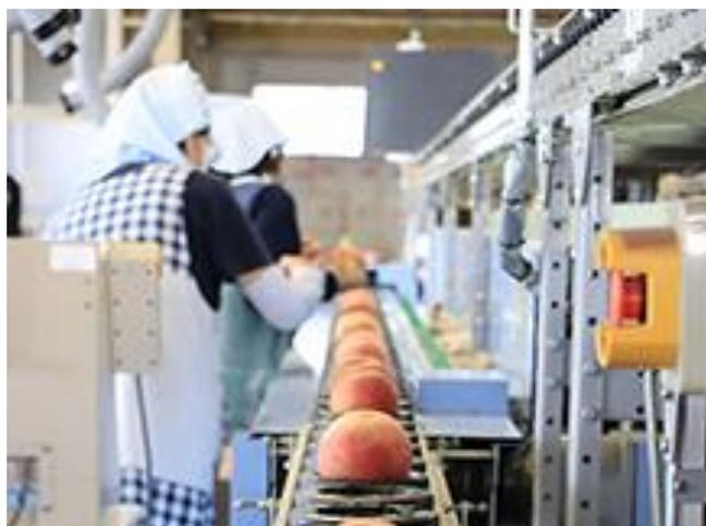
図4 光センサー選果機によるモモの選果
