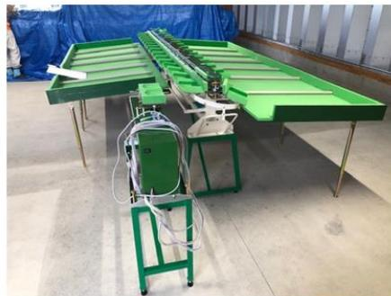
機械にあらかじめ分けたい選果規格をインプットし、選果を機械が行うことで、選果作業の時間が短縮され、作業の効率化を図ることができる
